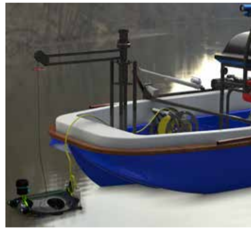
Надводная часть мобильной телеуправляемой робототехнической плавучей платформы в лодочном исполнении
