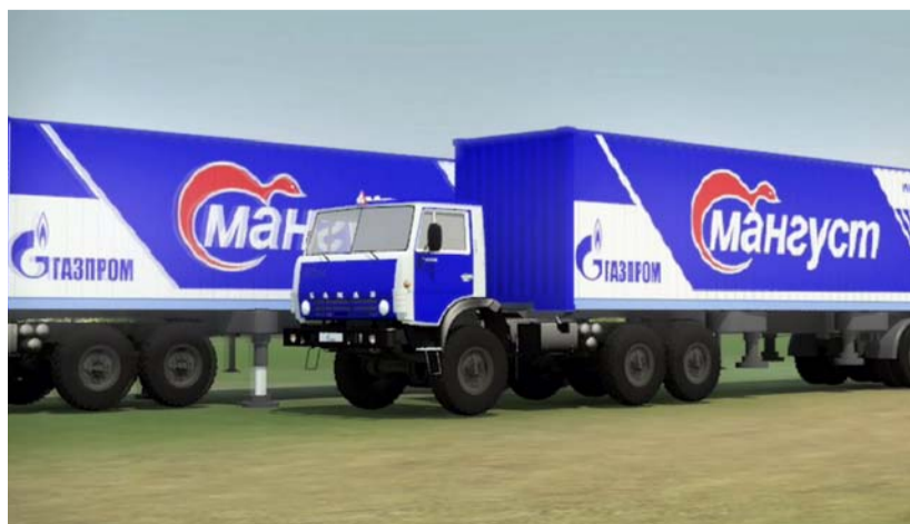
Среди преимуществ «Мангуста» – простое подключение к магистральному газопроводу, которое обеспечивается тем, что оборудование монтируется в автофургон на предприятии-изготовителе
