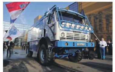
Специальная модель спортивного грузового автомобиля – «газовый КамАЗ»
